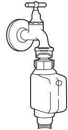
ống cấp nước an toàn
